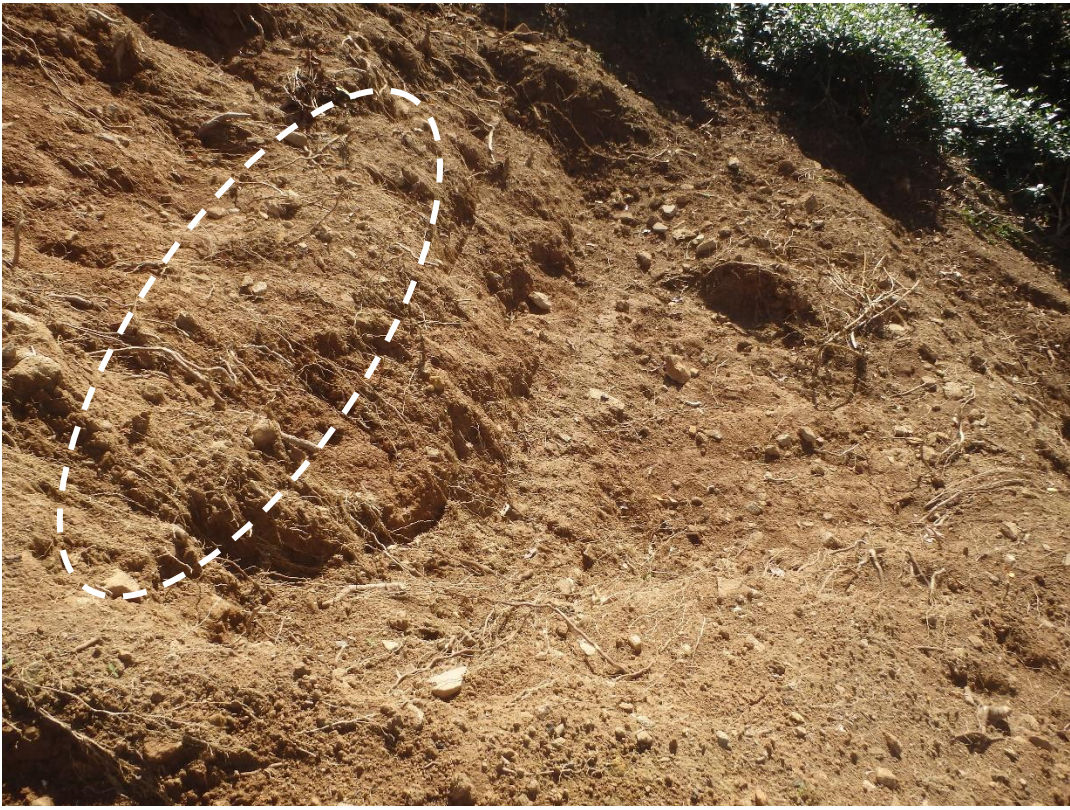
写真-3 ; 崩壊末端部 茶畑耕作土以深の水平土壤層理が縞状に見える
